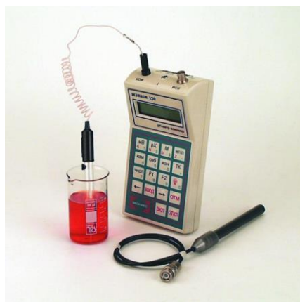
Портативный (переносной) pH-метр Экотест-120-pH/АТС (-20...+20)/±0,005 pH используется в полевых и лабораторных условиях
