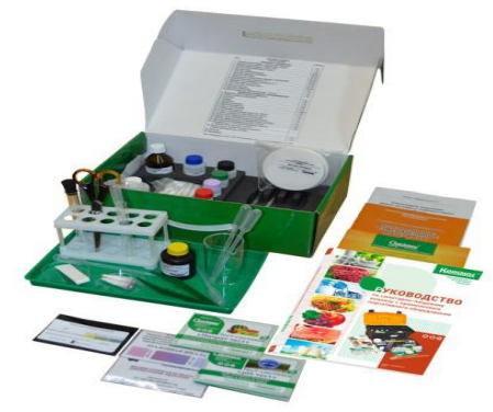
Модуль: Санитарно-пищевая экспресс-лаборатория учебная для оценки качества и безопасности пищевых продуктов СПЭЛ-У
