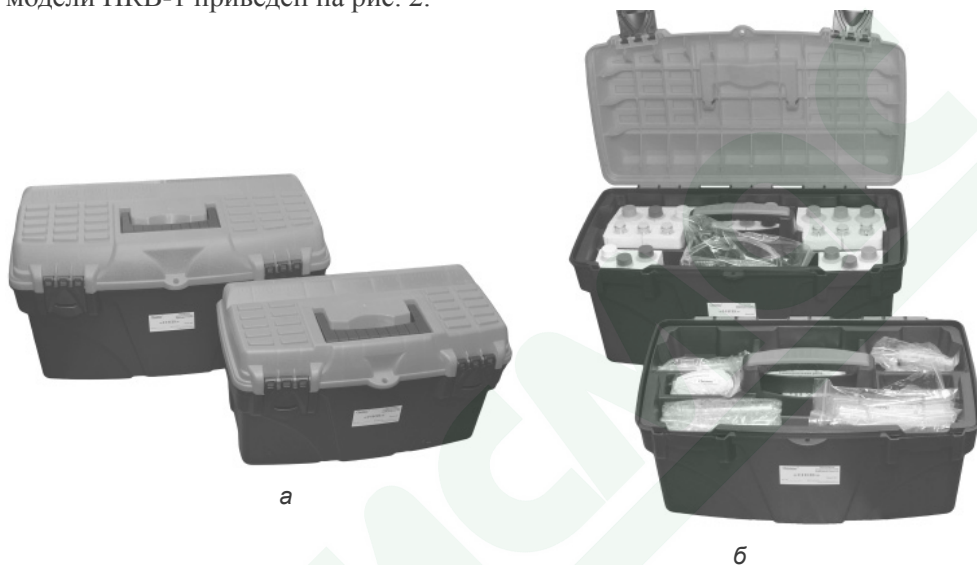
Рис. 2. Полевые лаборатории анализа воды модели НКВ-1 (номер заказа 3.100), в закрытом (а) и открытом (б) видах.
