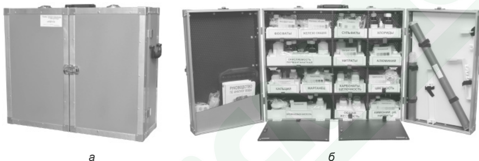
Рис. 3. Портативные лаборатории анализа воды НКВ-12 (модификация 3.120), в закрытом (а) и открытом (б) видах.
