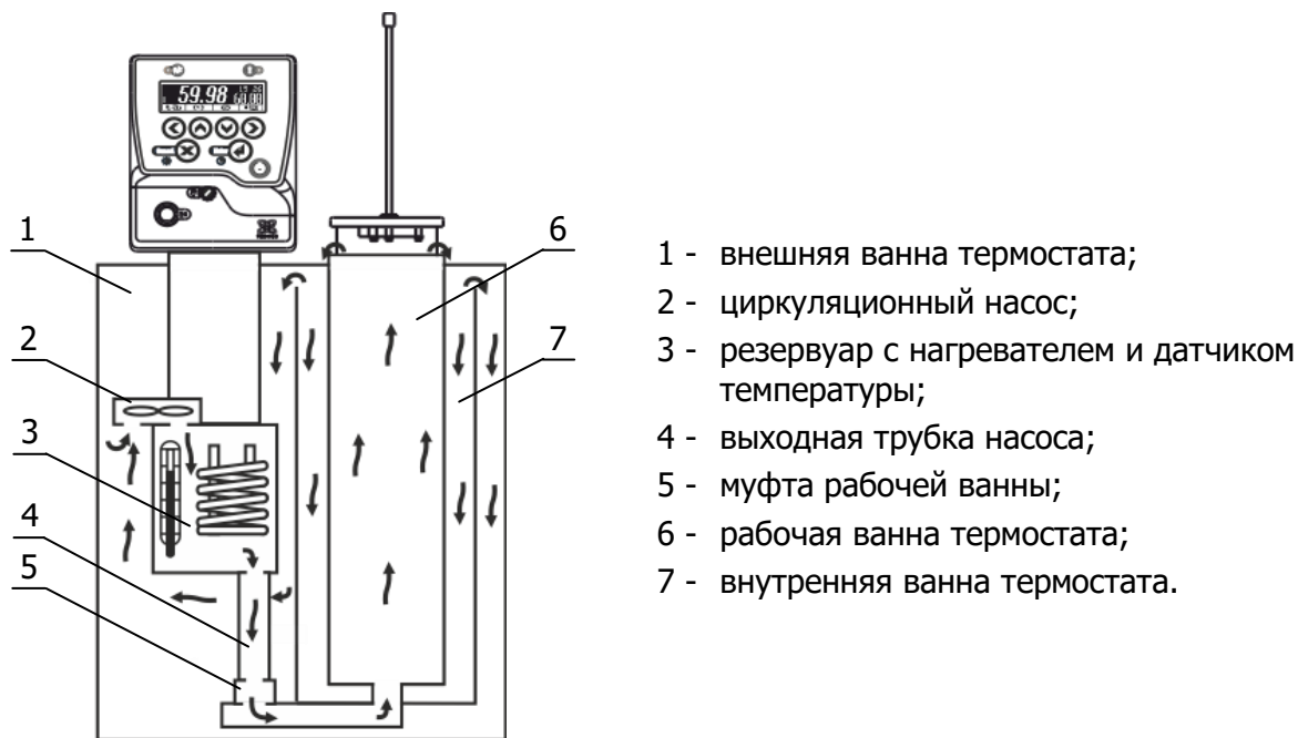
Рисунок 3 — Устройство термостата
