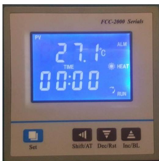
После окончания времени работы прибор прекратит нагрев и в течении 1 минуты будет издавать звуковой сигнал. В разделе дисплея «PV» будет отражаться остаточная температура внутри камеры, а в разделе дисплея «SV» будет гореть надпись «End».
