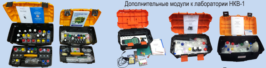
Полевая лаборатория анализа воды НКВ-1 (в двух контейнерах)
