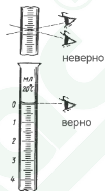
Рисунок 10. Наблюдение уровня жидкости (мениска) при титровании.
