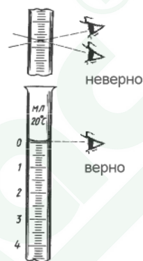
Рисунок 12. Наблюдение уровня жидкости (мениска) при титровании.
