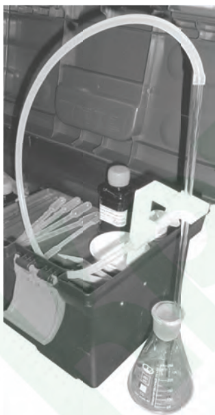
Рисунок 4. Принадлежности для количественного гидрохимического анализа из состава мини-лаборатории «Пчёлка-У/хим».
