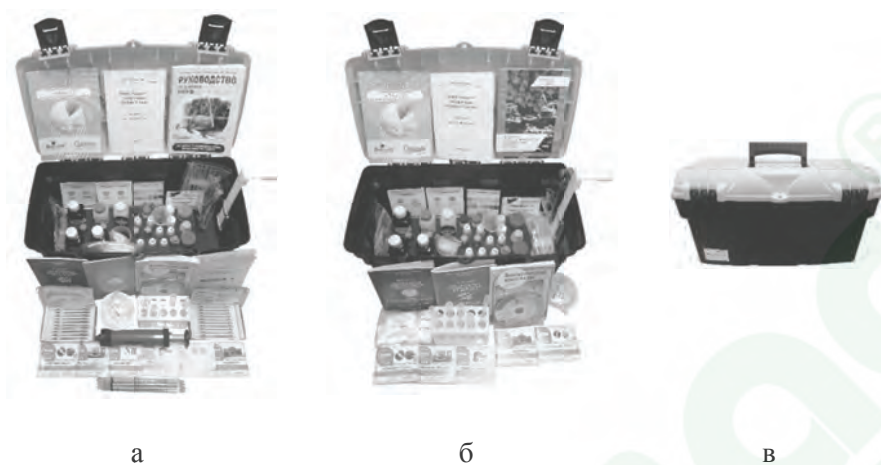
Рисунок 3. Мини-экспресс-лаборатории «Пчёлка-У»: а, б — изделия в модификациях «Пчёлка-У/хим» и «Пчёлка-У/почва», в — вид изделий в закрытом контейнере.
