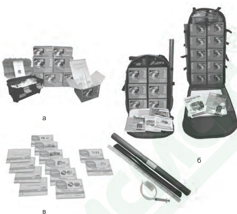
Рисунок 5. Внешний вид некоторых тест-комплектов и тест-систем для анализа воды: а — тест-комплекты различного типа; б — тест-комплекты в составе ранцевой полевой лаборатории модели НКВ-Р; в — тест-системы.
